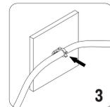
Vous pouvez utiliser les serre-câbles de fixation inclus pour fixer le cordon lumineux. Fixez les serre-câbles de montage avec les vis sur les surfaces et fixez le cordon lumineux en place.
