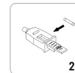
Retirer le fusible avec précaution. Risque d'incendie. Remplacer le fusible uniquement par un fusible de 5 A, 125 V. Sinon, il peut y avoir un risque d'incendie. Fusible (1 pièce) contenu dans la fiche.
