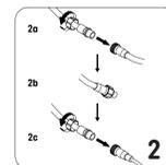
Vous pouvez relier d'autres ensembles de cordons lumineux (jusqu'à 100 pi) en dévissant le capuchon en plastique à l'extrémité du cordon lumineux pour accéder au port de connexion(2a). Laissez-le couvert si vous ne voulez pas relier d'autres lumières(2b). Connecter le cordon lumineux au cordon d'alimentation en vissant fermement le capuchon en plastique sur le cordon lumineux(2c).
