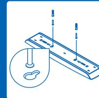
Installer deux vis sur la surface de montage avec un espace de 11 cm (4,3 po), comme indiqué ci-dessus. Accrocher la barre lumineuse sur les vis.
