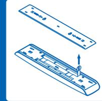
Ouvrir le capot arrière et retirer la languette en plastique du compartiment à piles, puis refermer le capot.
