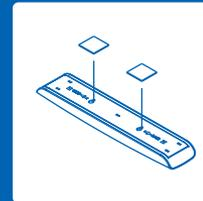
Fixez le ruban adhésif double face au capot arrière de la barre lumineuse, puis collez-la à un endroit sec et propre.
